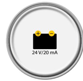
Spannungsversorgung 2-Leiter 4...20 mA
